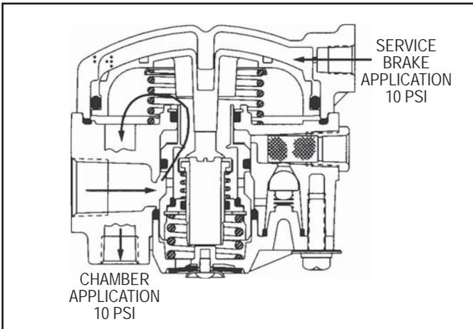
FIGURE 8 RE-6™ & RE-6NC™ RELAY VALVES SERVICE APPLICATION
