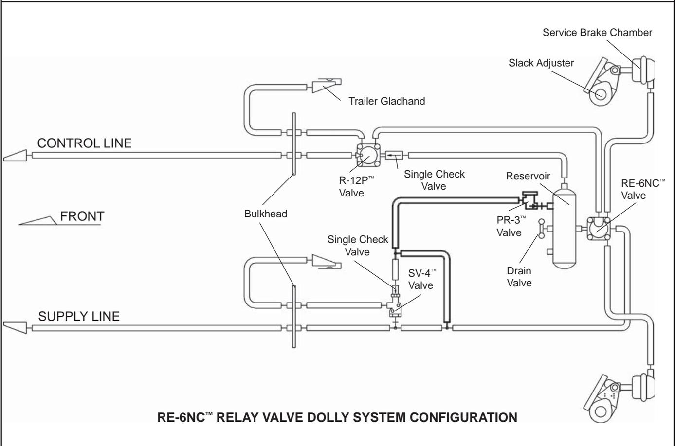
FIGURE 3 - RE-6™ & RE-6NC™ RELAY VALVES SYSTEM CONFIGURATION
