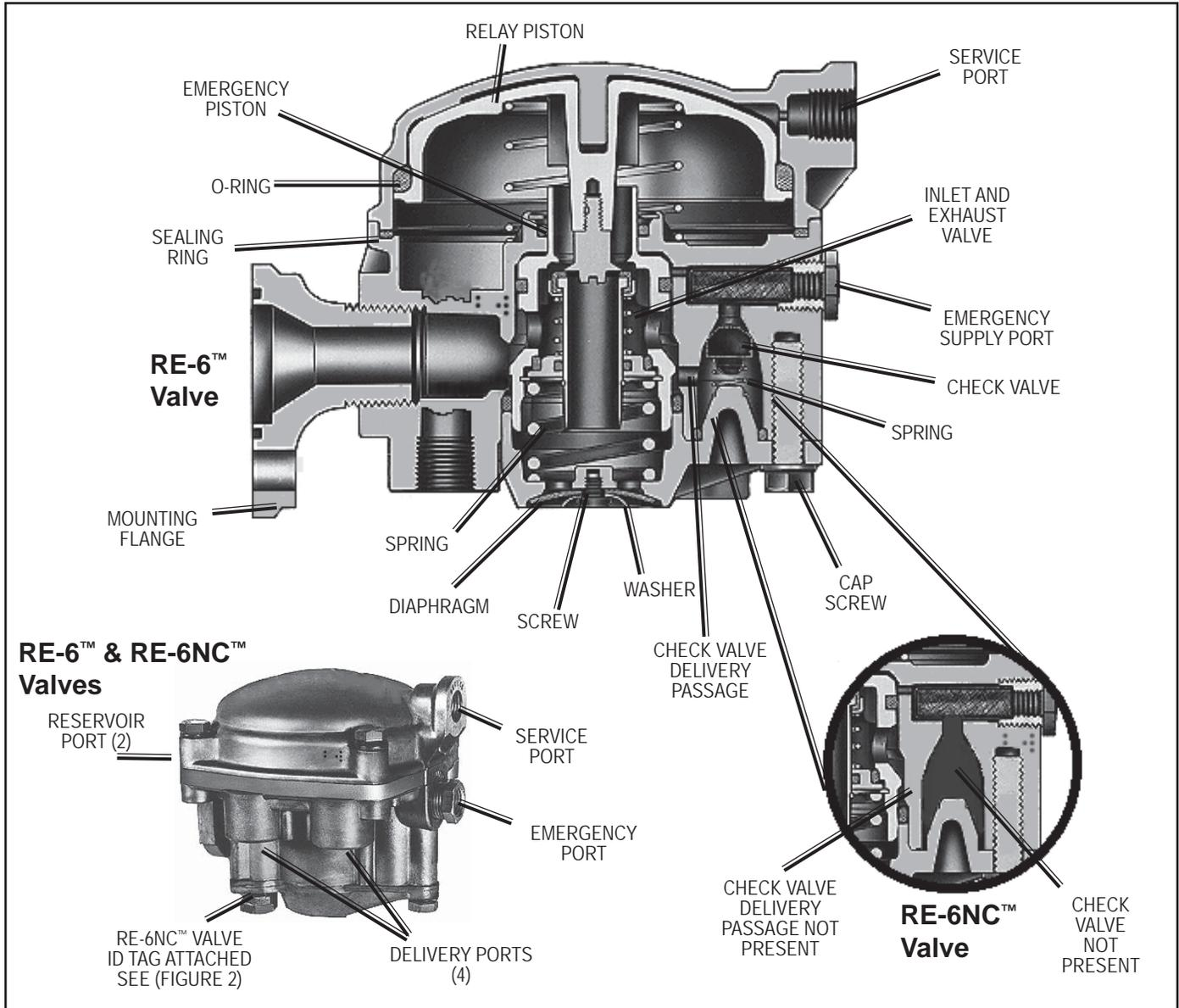
FIGURE 1 RE-6™ & RE-6NC™ RELAY VALVES
