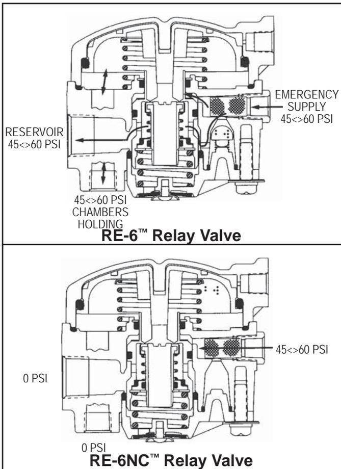
FIGURE 5 RE-6™ & RE-6NC™ RELAY VALVES CHARGING HOLD POSITION
