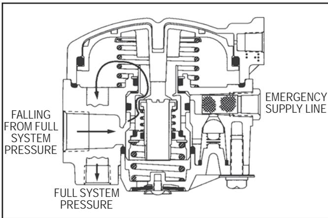
FIGURE 11 RE-6™ & RE-6NC™ RELAY VALVE EMERGENCY APPLICATION
